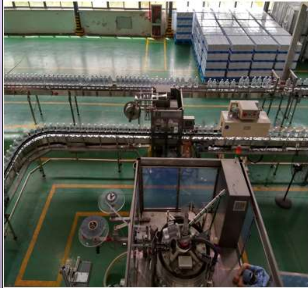
مراحل تعبئة قارورات المياه وتغليفها بمحطة التحلية
